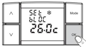
Premir a tecla **OK** para memorizar e passar à configuração seguinte, ou mantê-la premida durante, pelos menos, 4 s para guardar a nova configuração, e sair do menu de programação.
