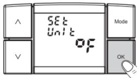
Premir a tecla **OK** para memorizar e passar à configuração sucessiva, ou mantê-la pressionada durante, pelo menos, 4 s para guardar a nova configuração, e sair do menu de programação.
