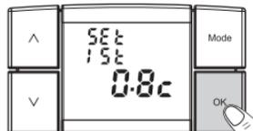
Premir a tecla **OK** para memorizar e passar à configuração seguinte, ou mantê-la pressionada durante, pelo menos, 4 s para guardar a nova configuração, e sair do menu de programação.
